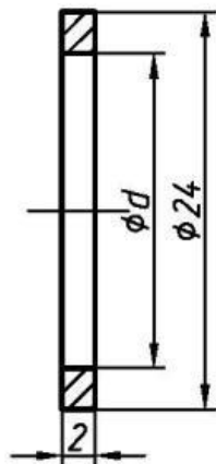
Рисунок А.19 – Шайба. Материал – сталь 09Г2С или сплав Д16Т. Размеры см. в таблице А.9
