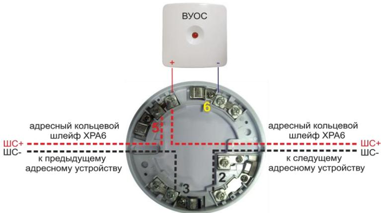
Рис.3 Схема подключения извещателя
