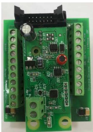
Рисунок 4 – Клеммная плата извещателя
