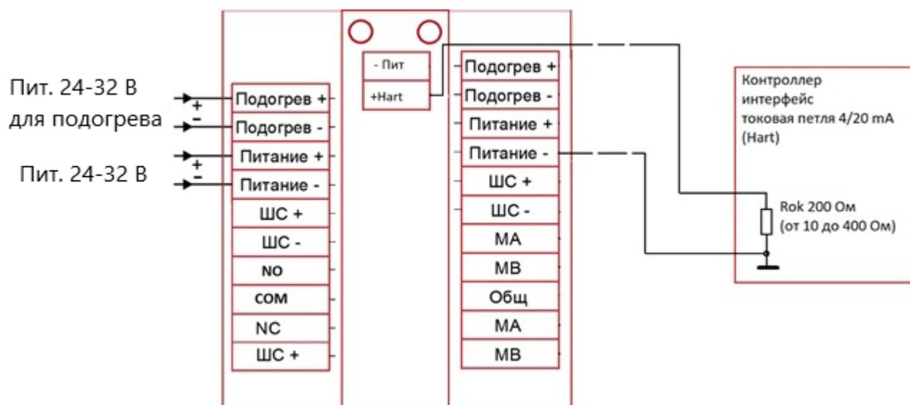
Рисунок 7 – Схема подключения извещателя с выходом 4-20 мА.
