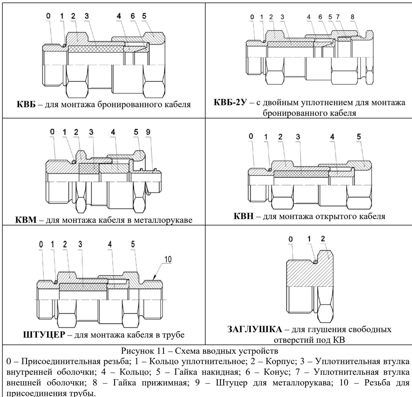
Рисунок 11 – Схема вводных устройств
