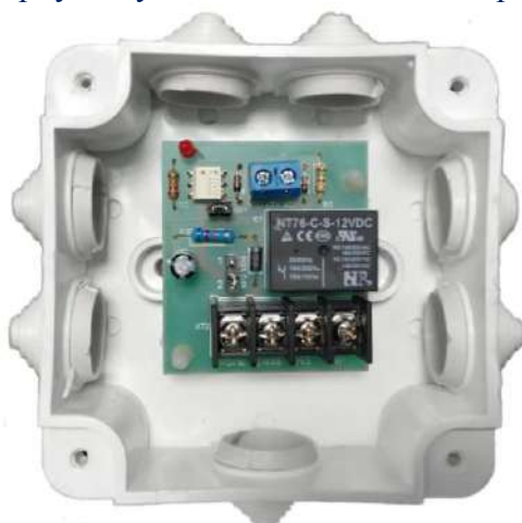
Рисунок 94. Внешний вид БУН1-12С (со снятой крышкой корпуса).
