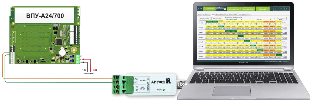
Рисунок 126. Схема подключения для конфигурирования ВПУ-А24/700
