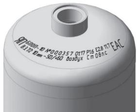
Чертеж 4 Маркировка баллона
