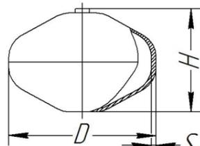
Чертеж 2 Н- высота баллона, D-диаметр баллона
