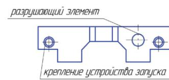
Чертеж 3 Крепление устройства запуска
