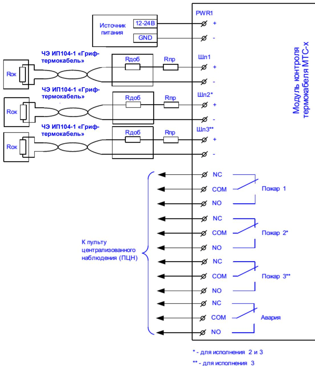
Рисунок 3. Схема подключения ЧЭ ИП104-1-t-s «ГРИФ-термокабель» к МТС-1, 2, 3.
