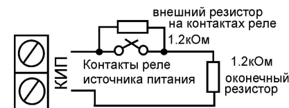
Рисунок 7. Подключение шлейфа контроля источников питания
