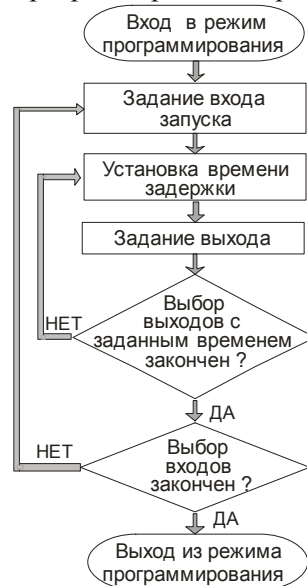
Рисунок 11. Блок схема алгоритма программирования
