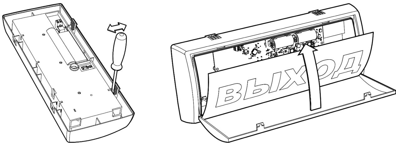
Разъемы для подключения основной ("Primary") и резервной ("Secondary") батарей (12) расположены на плате под прозрачной крышкой (6) с экраном (5). Для включения устройства необходимо извлечь изолирующие вставки из указанных разъёмов.
