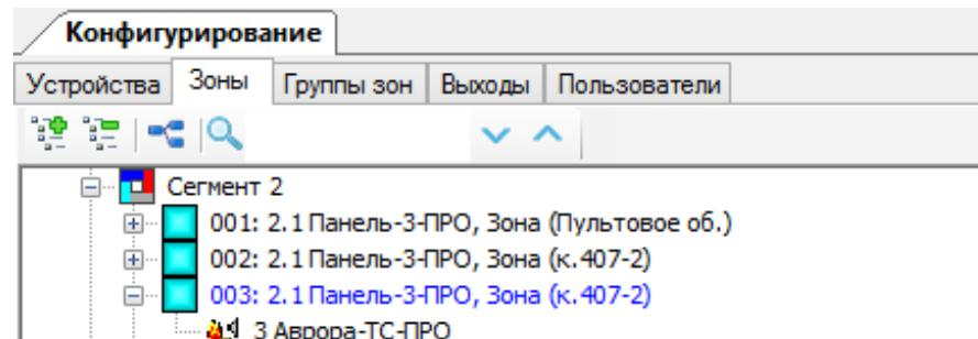
8. На вкладке «Выходы» перетащить устройство (-а) из окна «Система» в «Группу выходов».
