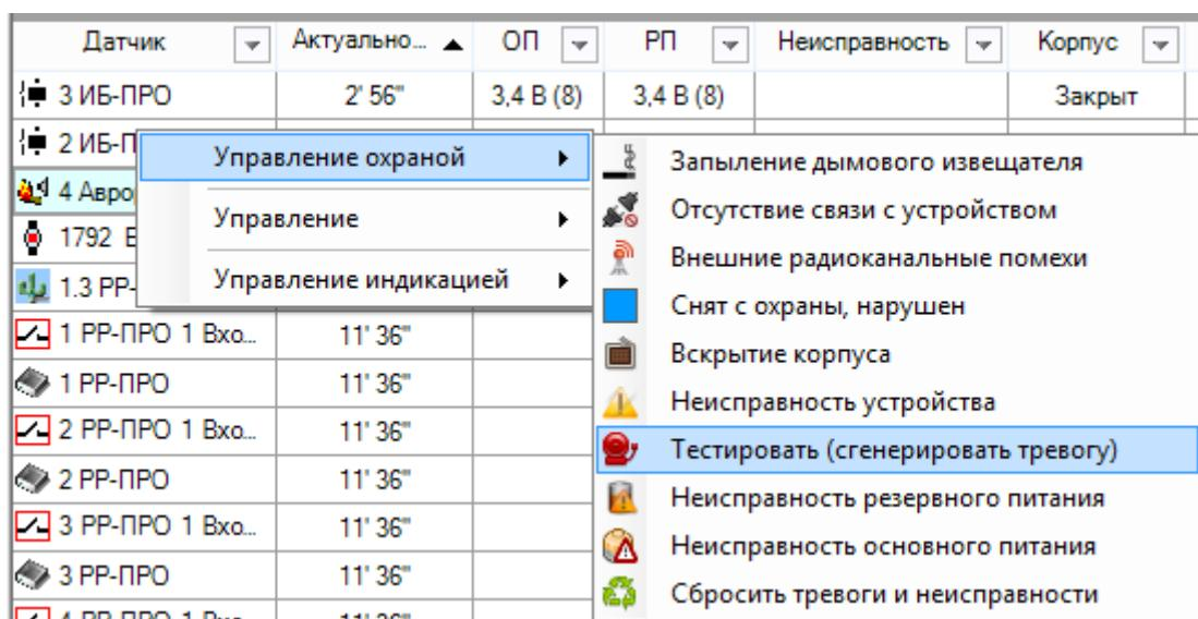
При тестировании устройство передаёт к ПКУ извещение “Пожар”.
