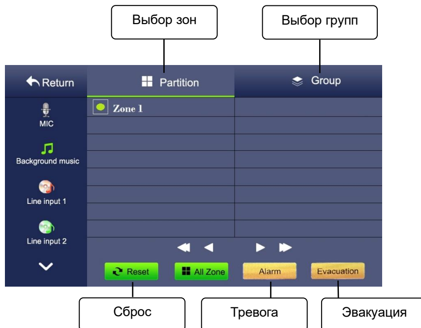
Рис. 4.4. Выбор зон/групп зон для трансляции пожарного оповещения
