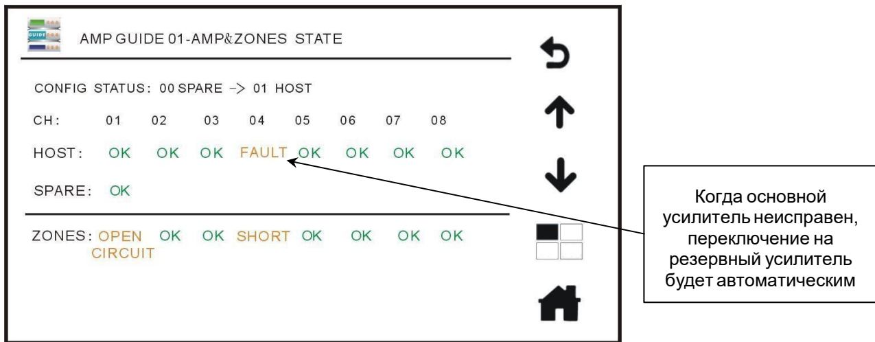
Рис. 4.13. Состояние переключения на резервный усилитель в окне
