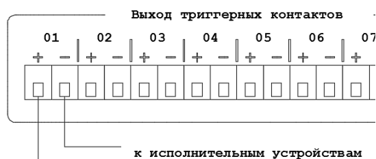
Рис. 3.5. Схема подключения внешних исполнительных устройств к LPA-PRESTA-16.
