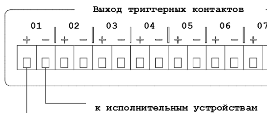
Рис. 3.5. Схема подключения внешних исполнительных устройств к LPA-PRESTA-2.
