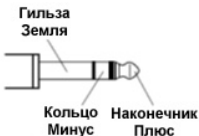
Рис. 4.1. Назначение контактов штекера TRS jack 6.35 мм
