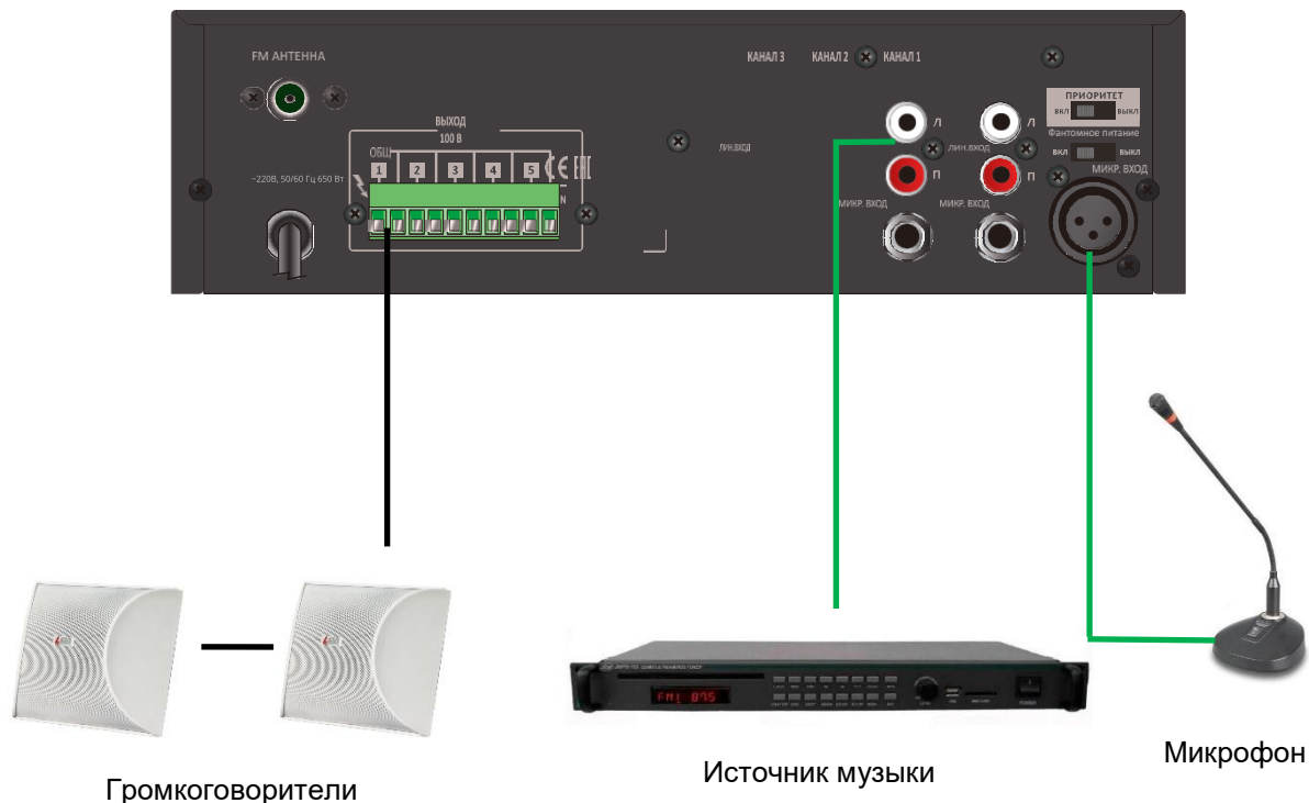
Рис. 2.1. Схема подключения LPA-TA-650MZ
