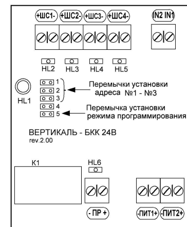
Рисунок 3 - Расположение индикаторов и перемычек на плате БКК
