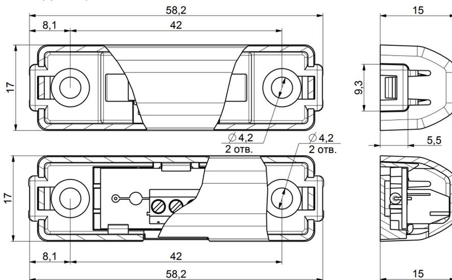
Рис.1. Габаритные и установочные размеры
