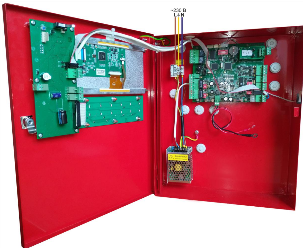
Рисунок 11. Подключение сетевого питания к ППКПиУ «Бирюза-М»
