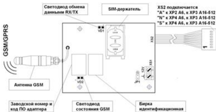
Рис. 1. Внешний вид адаптера GSM (кабель подключения к АКБ условно не показан)
