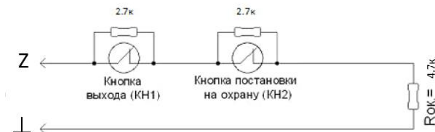
Рис. 4. Схема подключения в шлейф «Кнопки постановки на охрану» и «Кнопки выхода»
