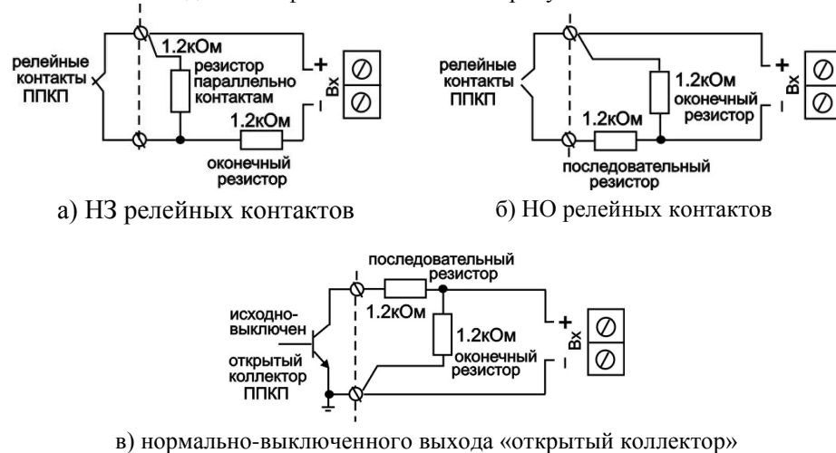
Рис.1 - Схема подключения контактов к технологическим шлейфам
