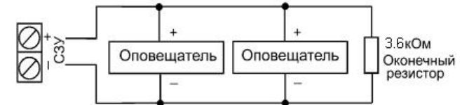
Рис. 2 Схема подключения оповещателей
