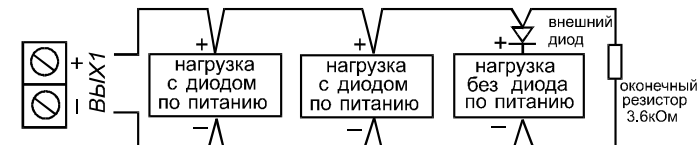
Рис.3 - Схема подключения нагрузки к выходу «ВЫХ1»
