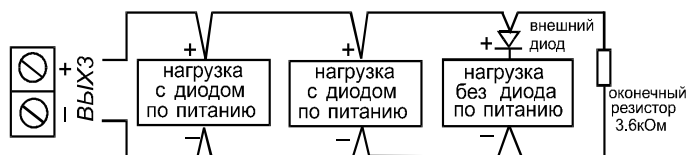
Рис.3 - Схема подключения нагрузки к выходу «ВЫХ3»
